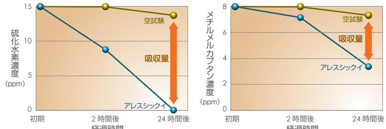
※アレスシックイ塗装板を5Lテトラーバッグにセットし、一定濃度の硫化水素又はメルカプタン含有空気を封入し系内の該化合物濃度を測定。
